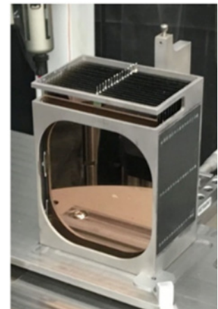
Fig. 7— Arcus Off-Plane Grating Module.
